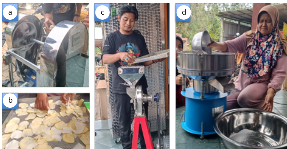
Gambar 5. Uji coba mesin produksi: (a) mesin perajang; (b) loyang mesin oven; (c) mesin penepung; (d) mesin pengayak
