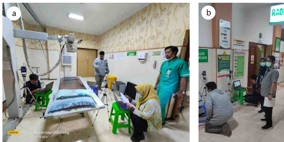
Gambar 3. Pengukuran langsung dan data penggunaan pesawat sinar x: (a) persiapan pengukuran paparan radiasi ruang X-ray; (b) pengukuran paparan radiasi di luar ruang X-ray
